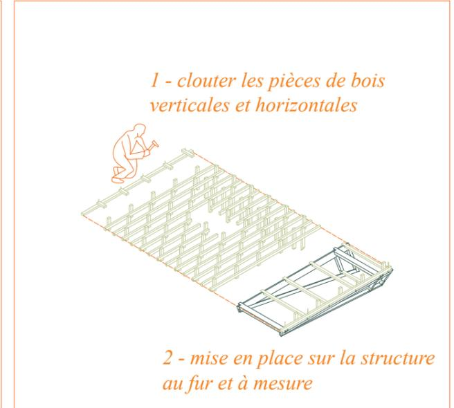
**Etape 5 : assemblage puis installation des pieds en mi-bois sur le site, avec ajustement de leur hauteur à la topographie**
