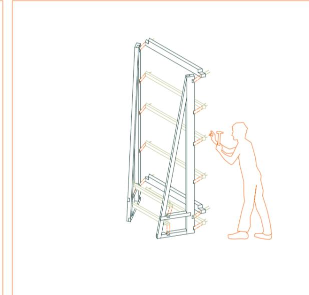
**Etape 4 : fixation du bardage moisé, monté au fur et à mesure sur les modules positionnés à l'horizontal**
